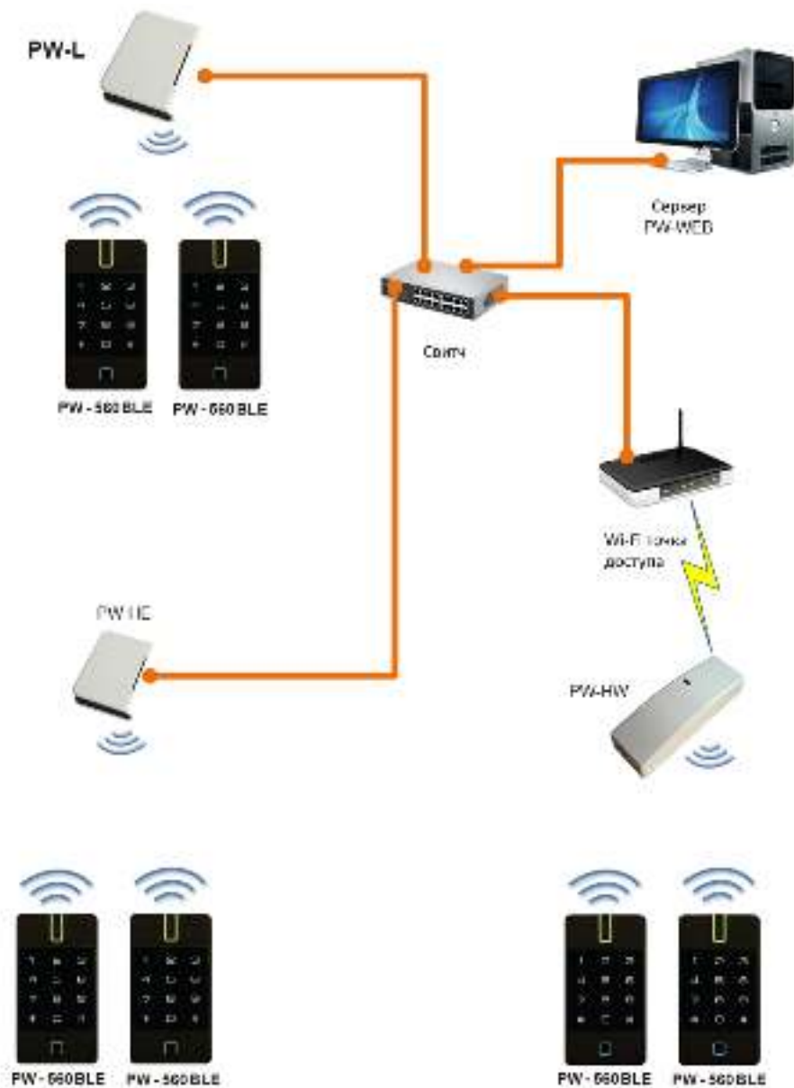
Рис 3. Пример локальной сети смешанного типа (Ethernet и Wi-Fi)
