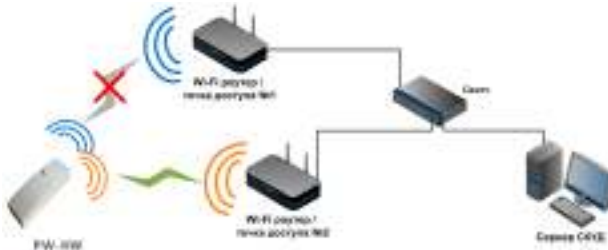
Рис 5. Работа с несколькими Wi-Fi точками доступа
