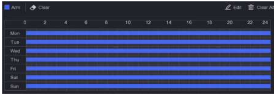
Рисунок 5-14 Настройка расписания постановки на охрану
