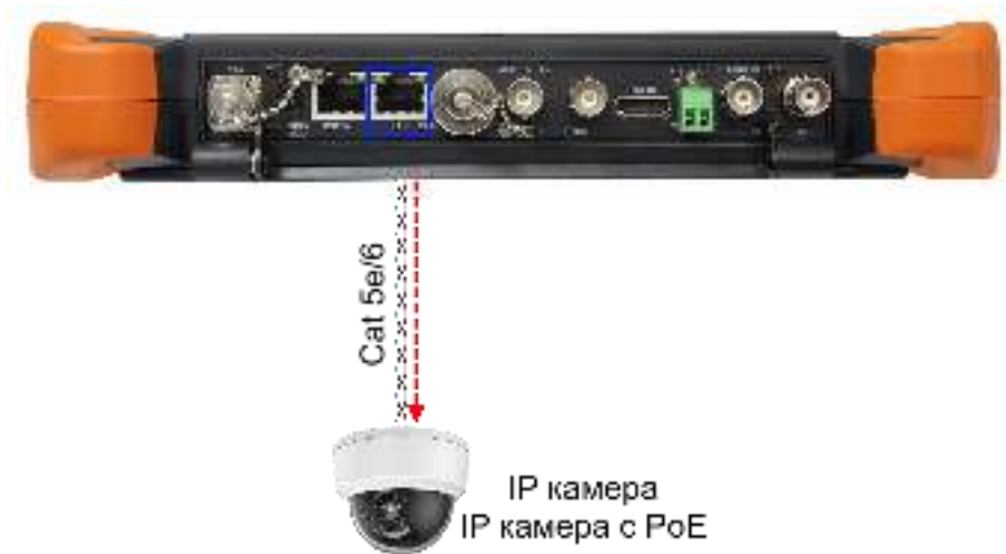
Рис. 15 Подключение IP-видеокамеры (в том числе с PoE питанием)
