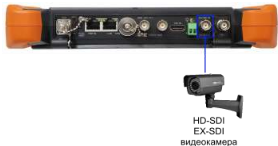
Рис. 11 Подключение HD-SDI или EX-SDI видеокамеры к тестеру
