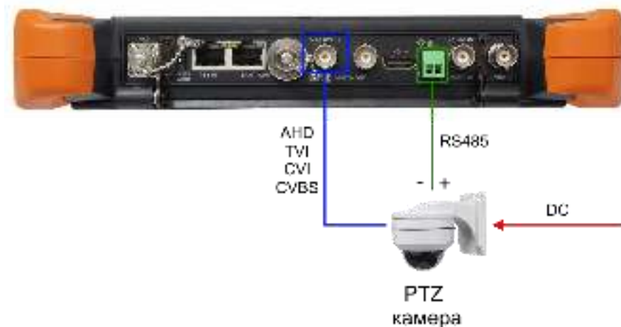
Рис.7 Подключение управляемой PTZ видеокамеры к тестеру
