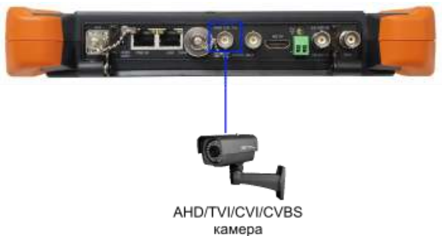
Рис.2 Разъем для подключения AHD/CVI/TVI/CVBS видеокамер
