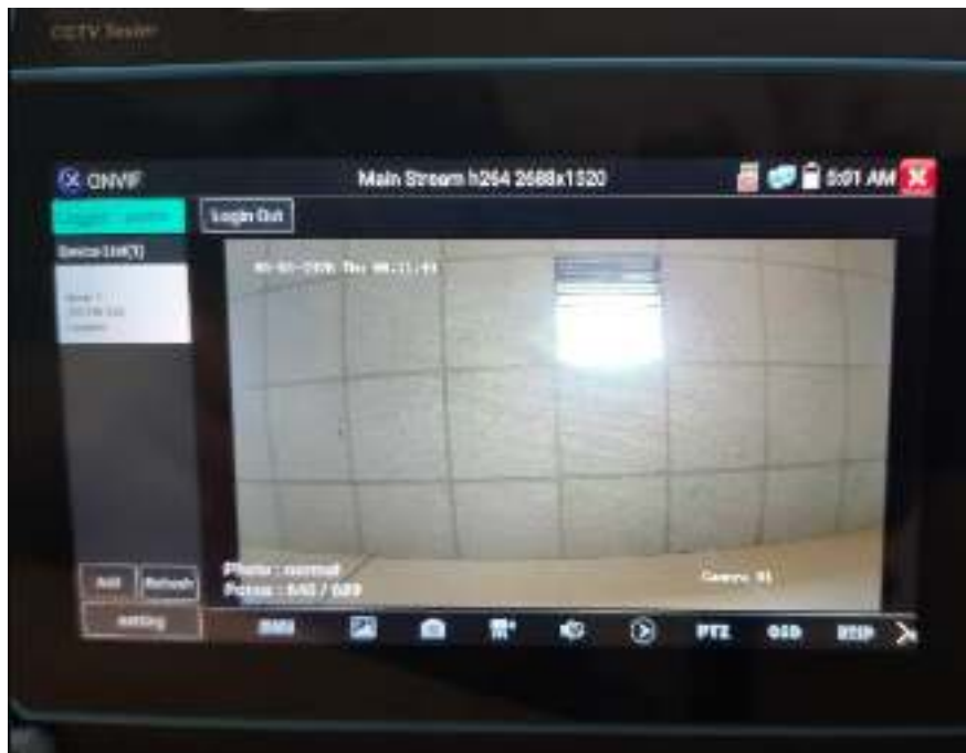
Рис. 24 Пример успешного подключения IP-видеокамеры к тестеру через ONVIF
