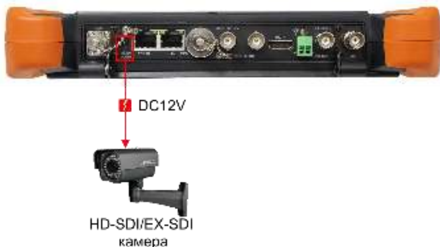
Рис. 13 Подключение питания к видеокамере HD-SDI или EX-SDI
