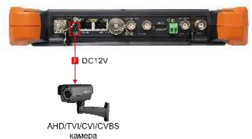
Рис. 4 Подключение питания DC 12V к видеокамере с использованием тестера
