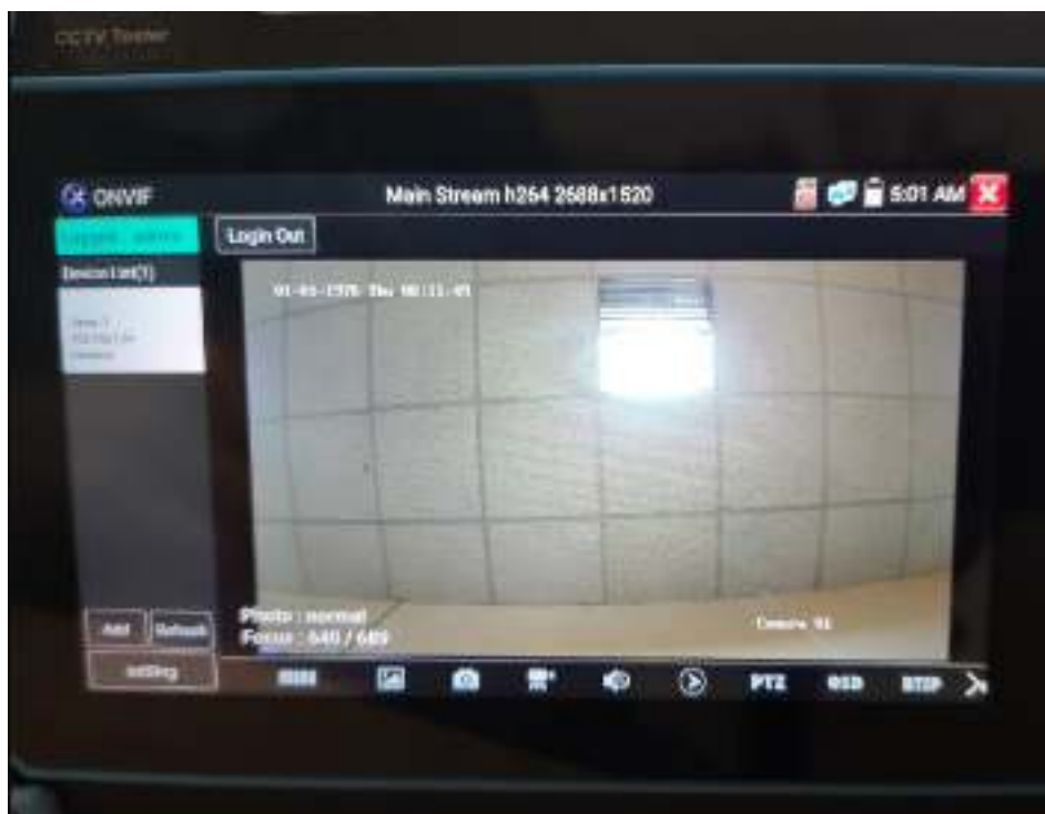
Рис. 21 Пример успешного подключения IP-видеокамеры к тестеру через ONVIF
