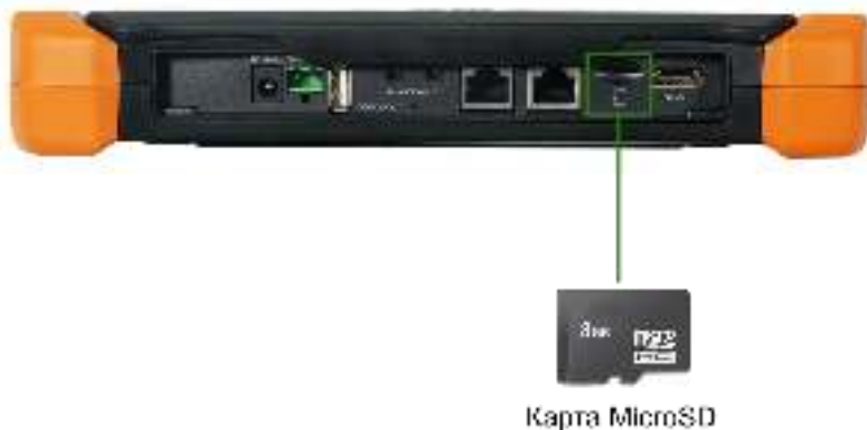
Рис. 27 Установка карты в Micro SD слот
