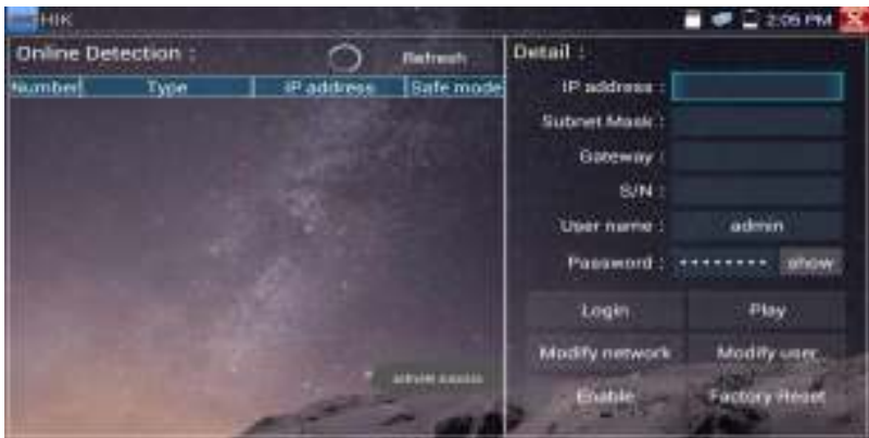
Рис. 112 Завершение активации видеокамеры Hikvision
