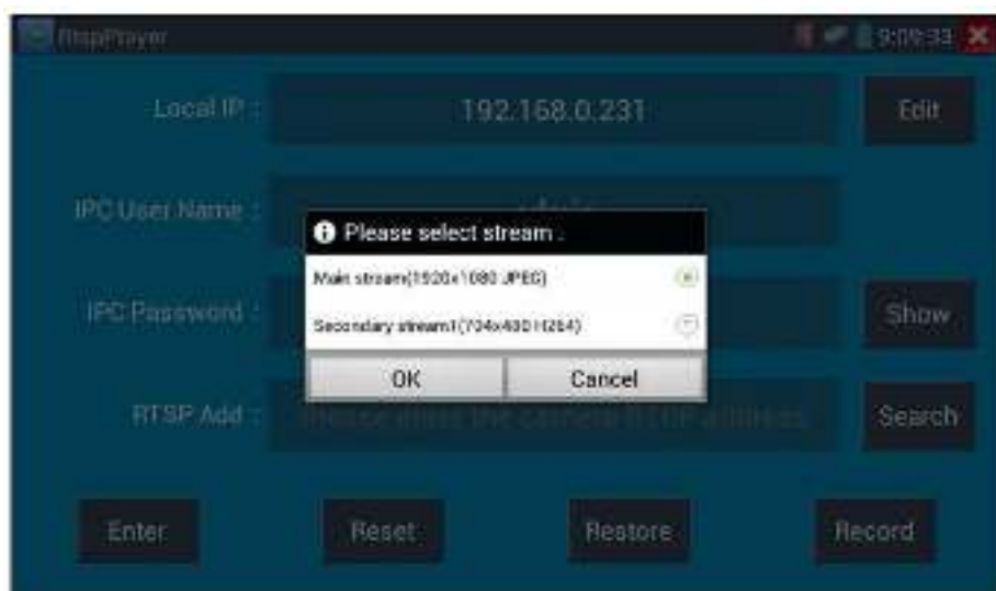
Рис. 109 Просмотр изображения с помощью RTSP плеера
