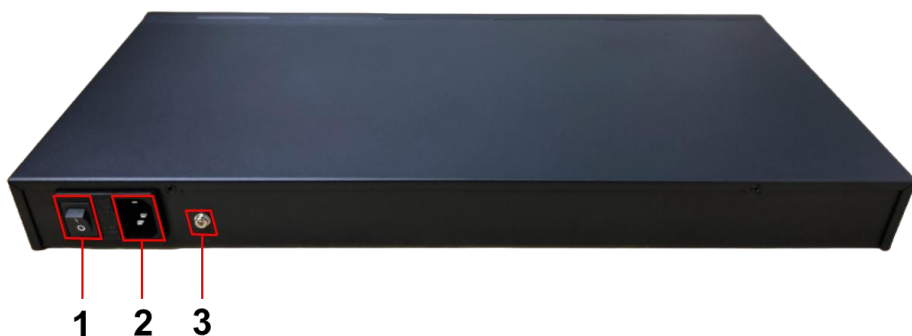
Рис. 3 Коммутатор SW-24G4SF-L2, разъемы и кнопки на задней панели
