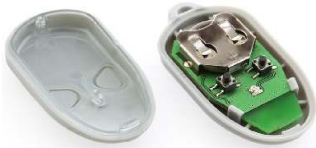
Рисунок 2. Идентификатор со снятой крышкой. Видна батарея питания
